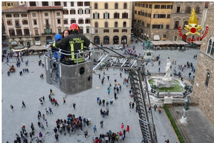
Fig.6 - Simulazione di salvataggio con ausilio di autoscala con cestello. Credits: Archivio autore.
